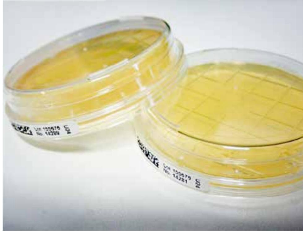
RODAC-Platten zur Beprobung von Oberflächen im Abklatsch-Verfahren
